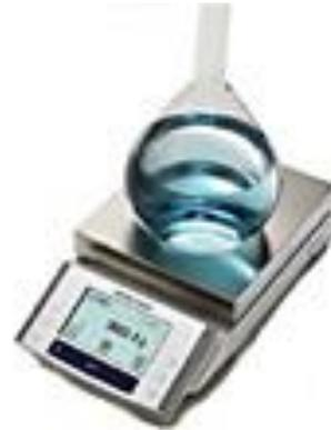
La balance doit se trouver dans un emplacement stable, horizontal et sans vibrations.
